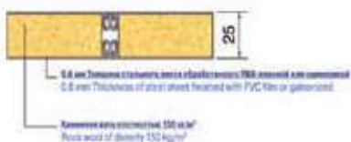
WHL-TA25 В15 облицовочная панель 25 мм толщиной (Тип A) B15 Panel of 25 mm thi. (Type A)
